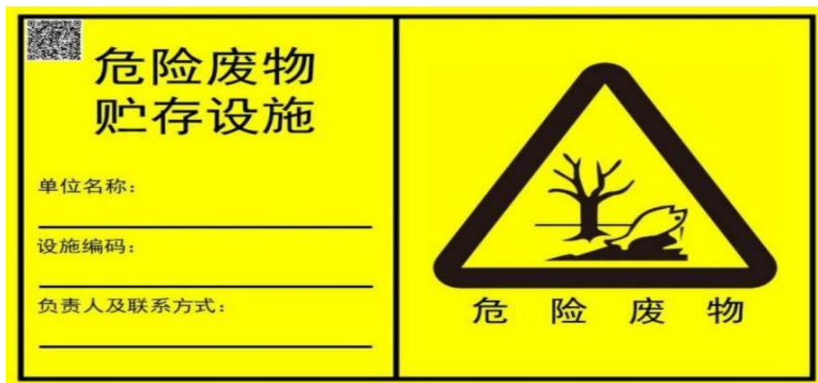
图 10.4-2 危险废物贮存警示识别标志牌
